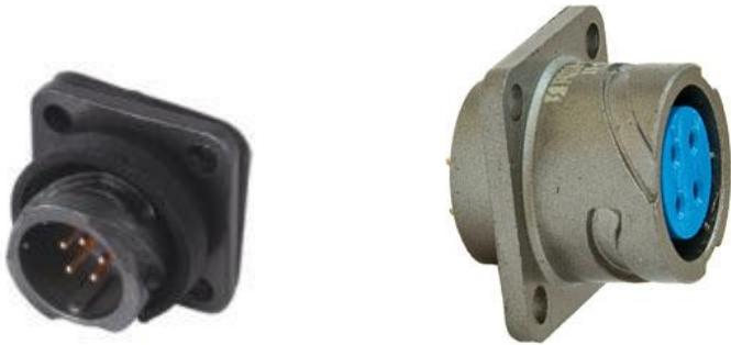
Цилиндрические соединители серии **FQ24**. Разъем устанавливается на блок с помощью монтажного фланца. Контакты штыревые (вилки) и гнездовые (розетки), под пайку провода. Разъёмы соединяются байонетным сочленением. Использование высококачественных материалов обеспечивает низкое сопротивление контактов, высокую виброустойчивость, ударостойкость, влагозащищенность и хорошую изоляцию этих соединителей. Применяются в электрических сетях постоянного и переменного тока.
