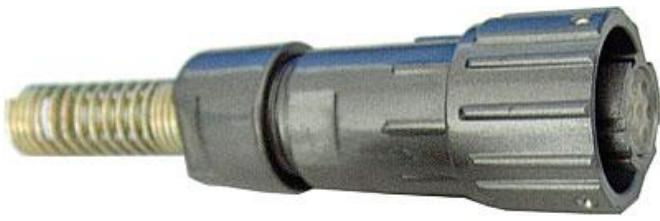
Цилиндрические соединители серии FQ18. Разъем имеет гибкий амортизатор для кабеля. Максимальный диаметр устанавливаемого кабеля 10 мм. Контакты штыревые (вилки) и гнездовые (розетки), под пайку провода. Разъёмы соединяются байонетным сочленением. Использование высококачественных материалов обеспечивает низкое сопротивление контактов, высокую виброустойчивость, ударостойкость, влагозащищенность и хорошую изоляцию этих соединителей. Применяются в электрических сетях постоянного и переменного тока.
