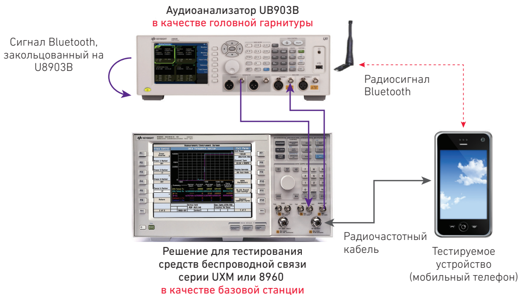
Рисунок 3. Пример тестирования передачи сигналов обратной связи – контроль качества аудиосигнала Bluetooth мобильного телефона.
